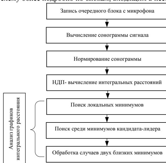
Рис.4. Последовательность действий при обнаружении ключевого слова в потоке речи
