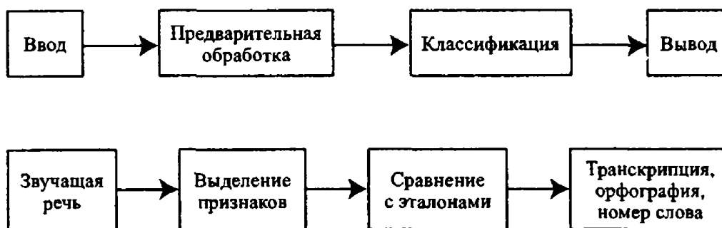
Рис. 3. Структурная схема устройства распознавания изолированно произнесенного слова
