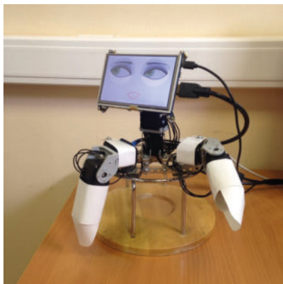
Рис.2. Робот Ф-2, совмещающий коммуникативные функции задумчивости (я-размышление — направление взгляда) и отрицания (движение левой рукой) из фрагмента корпуса REC 20081215- fpp-a05(00:54.010)
