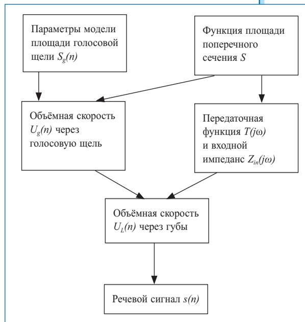
Рис. 1. Структура используемого частотно-временного артикуляторного синтезатора
